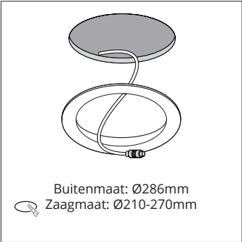
Buitenmaat: Ø286mm Zaagmaat: Ø210-270mm Opvulring Wit: 1029221 Zwart:1029238 Alleen voor Ø228mm versie (1000367-/-)
